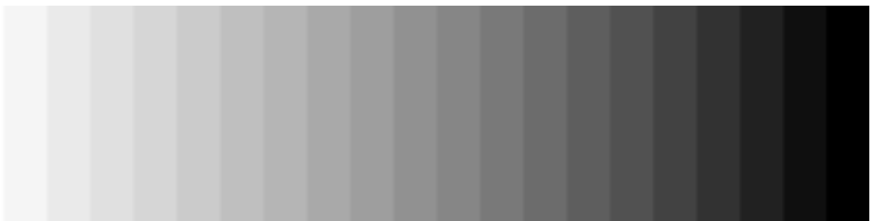
Escala de grises utilizada en el laboratorio químico y el laboratorio digital (photoshop). Esta significa realizar una cantidad de pasos específicos y similares ascendentes del blanco al negro. El objeto de la escala es encontrar el tiempo de exposición para la realización de las copias de un original.
